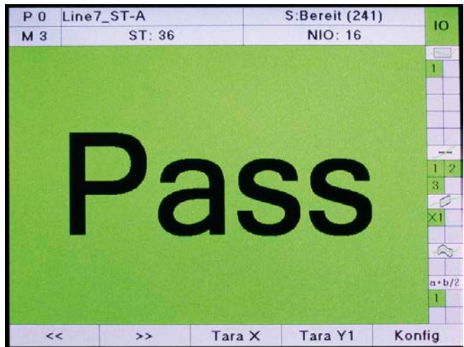
Bild: Eine Vollbild-PASS/FAIL-Ampel visualisiert dem Bedienpersonal die globale IO/NIO-Bewertung (alternativ auch als OK/NOK-Smiley möglich).
