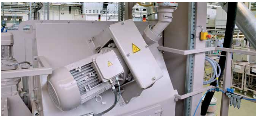
AGTOS Hochleistungsturbine mit Strahlmittelregulierung
