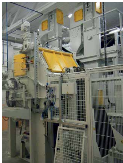
AGTOS Trommel-Strahlanlage mit Beschickungseinrichtung und Sicherheitszaun
