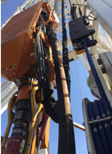
Bild 1 Die bisher übliche Lösung: Service Loops für die Energiezuführung an Tiefbohranlagen in „Top Drive“-Bauweise. Quelle: igus® GmbH
