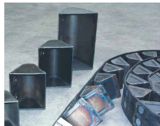
Becherwerksgurte, Becher und Schrauben für alle Strahlmaschinen-Fabrikate
