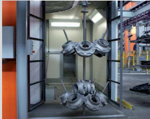
Gussteile beim Verlassen der manuellen Ablaskammer einer Doppelkammer-Hängebahn-Strahlanlage
