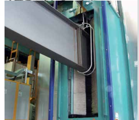
Ein Stahlträger nach dem Strahlvorgang in einer Durchlaufhängebahn-Strahlanlage
