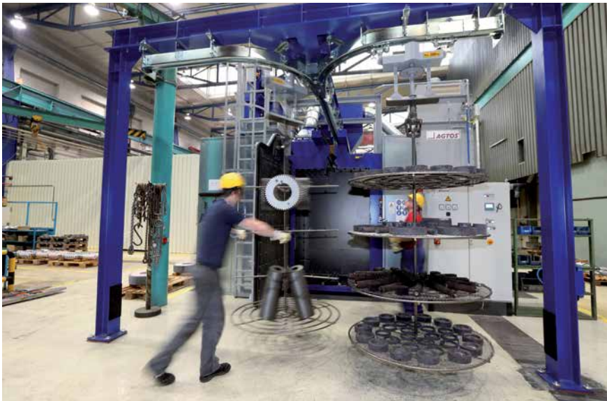
Hängebahn-Strahlanlage für Getriebeteile als Insellösung
