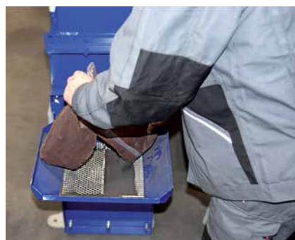
Strahlmittel-Nachfülltrichter am Becherwerk (optional)
