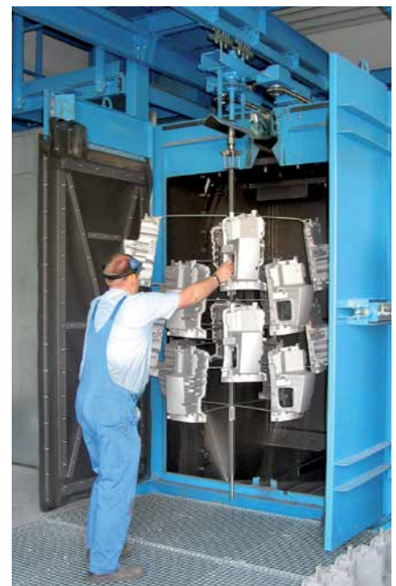
Hängebahn-Strahlanlage im Gießereibetrieb mit Magnetabscheider und Strahlmittelrückführung vor der Maschine
