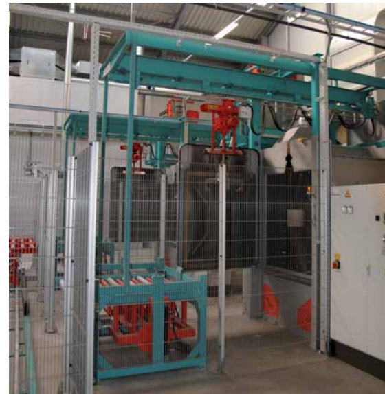
Hängebahn-Strahlanlage für Verbindungselemente in einer Bearbeitungslinie
