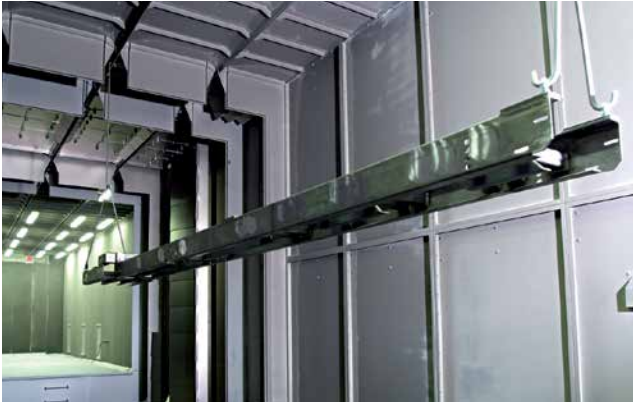
Durchlaufhängebahn-Strahlanlage für Schweißkonstruktionen mit manuellem Nachstrahl- und Abblasraum
