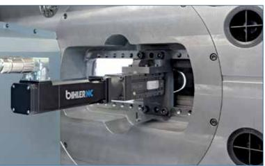
Optional integrieren Sie NC-gesteuerte Mittelstempel.
