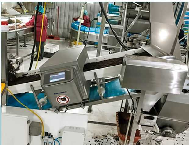
Der Metalldetektor ist platzsparend auf dem schräg verlaufenden Motorisierungssystem installiert
