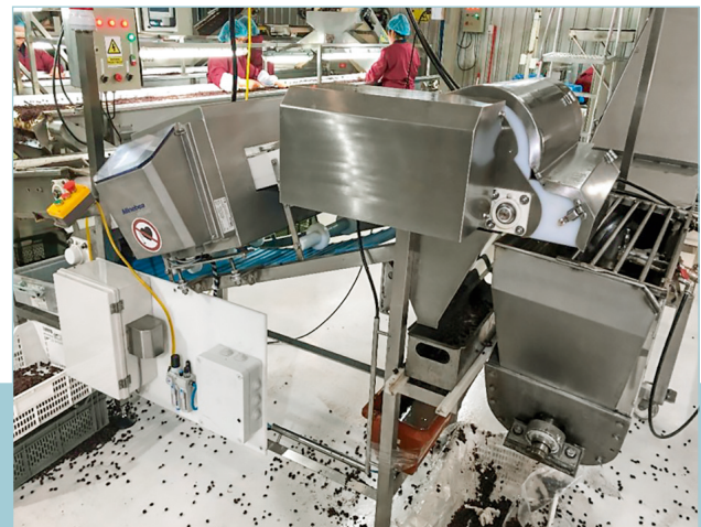
Alle ausgeschleusten Produkte werden durch die Zwei-Wege-Klappe aus dem Produktstrom entfernt
