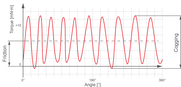
Bild 2: Beispiel einer typischen Kurve von Nutrasten. Das Reibungsmoment ist ein Durchschnittswert, der aus dem Drehmoment 0 berechnet wird. Der Nutrastwert wird anhand des Spitzendrehmomentwerts berechnet.
