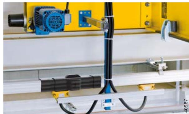
Demag Kompaktschleifleitung DCL-Pro: Stromversorgung eines Laufkrans
