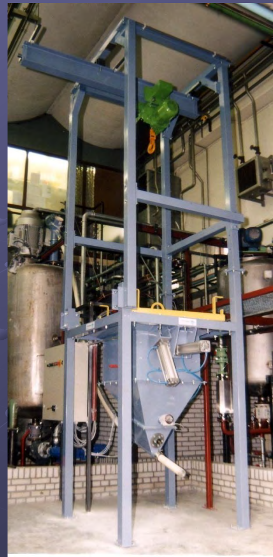
← ↑ Beladung der Station mittels integrierter Laufkatze zum Anheben und Hineinfahren der Big Bags
