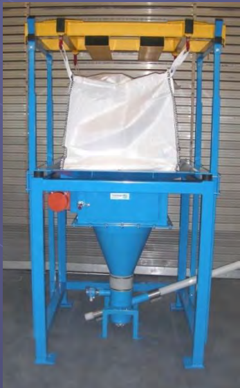
Station oben links mit Austragsgerät DZR für brückenbildende Produkte. Stationen oben rechts und unten mit Trichter für gut rieselfähige Schüttgüter
