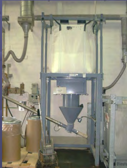
Station oben links mit Austragsgerät DZR für brückenbildende Produkte. Stationen oben rechts und unten mit Trichter für gut rieselfähige Schüttgüter
