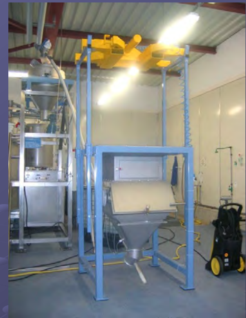
Big Bag Entleerstation mit zusätzlicher Sackschütte für gut rieselfähige Schüttgüter
