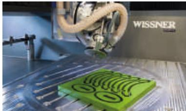
5D Bearbeitung mit Schwenkopf und Drehtischmodul
