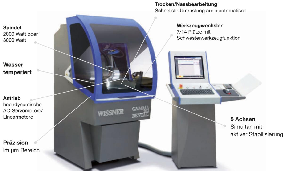
Fräsmaschinen der **GAMMA Dental-Baureihe** weisen **offene Schnittstellen** auf und können so flexibel mit **CAD/CAM-Komponenten** beliebiger Hersteller kombiniert werden. Alle dentalen Anforderungen – vom **Inlay, Onlay** über teil- und vollanatomisch konstruierte
