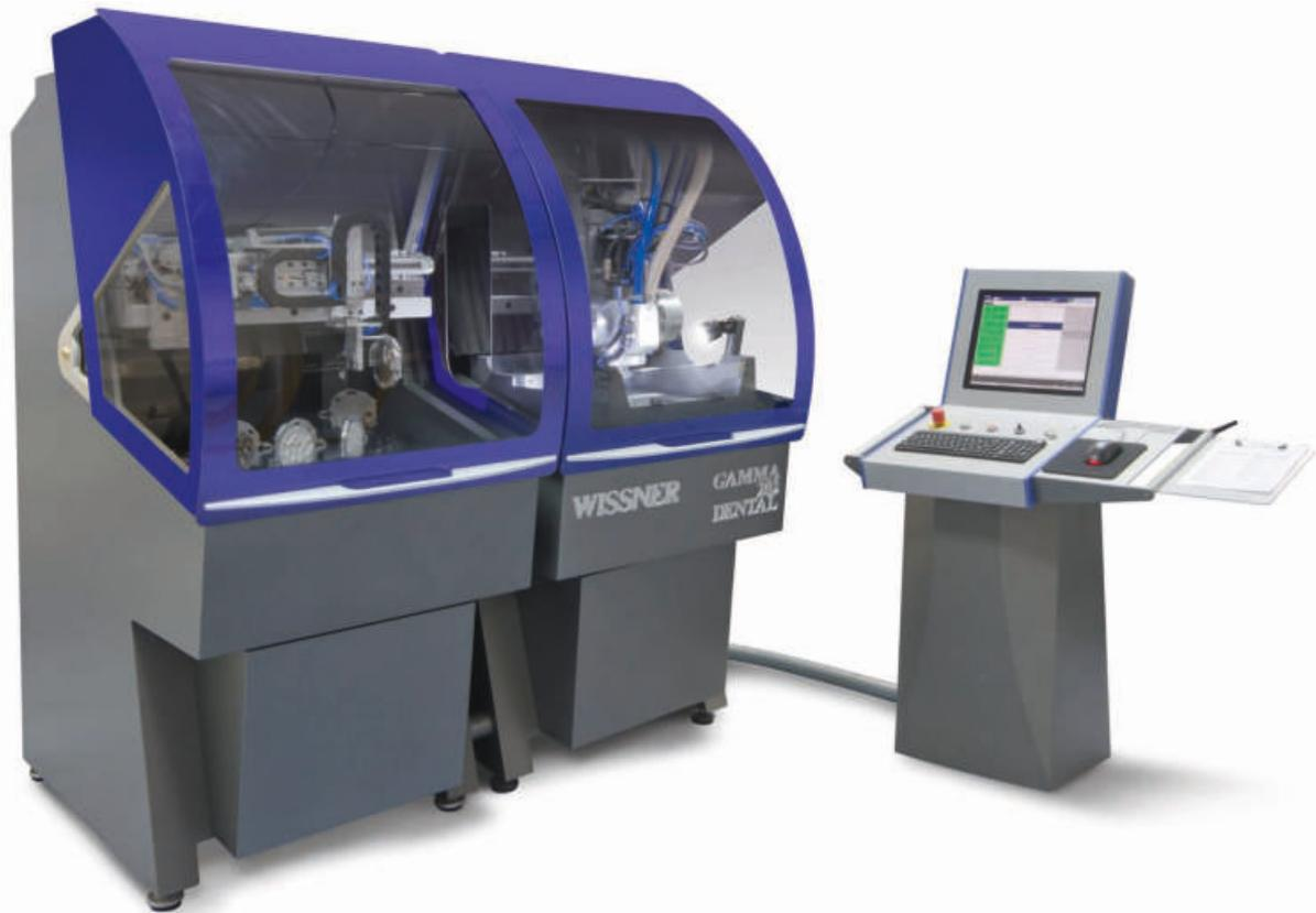
Zur Steigerung der Produktivität bieten wir zusätzlich einen Loader an, der auch nachträglich an die GAMMA 202 5D angeschlossen werden kann. Die Maschinensteuerung kontrolliert und überwacht das Gesamtsystem. Der Loader führt, ähnlich dem Jukebox-Prinzip, der Maschine automatisch bis zu 30 Rohlinge der unterschiedlichen Materialien zu.
