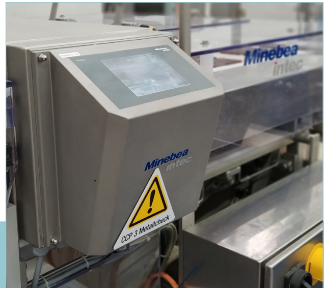
Durch das Bedienterminal und die Ampelfunktion sind wichtige Informationen mit einem Blick erkennbar.
