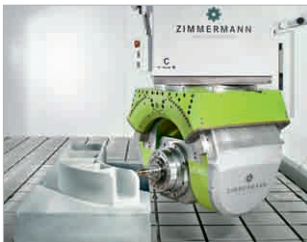
3-achsig simultan fräsen und dennoch riesige Schwenkbereiche – das kann nur der M3 ABC.
