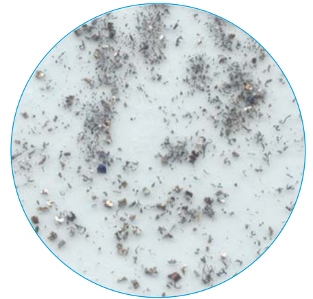
Metallische Partikel aus einem beidseitig geschnittenen Hydraulikrohr
