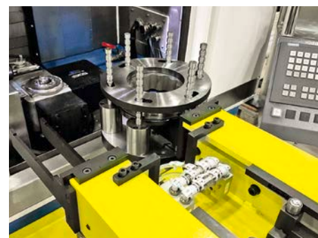
Wechselarm zum ergonomischen und schnellen Vorrichtungswchsel, dargestellt mit Spannvorrichtung
