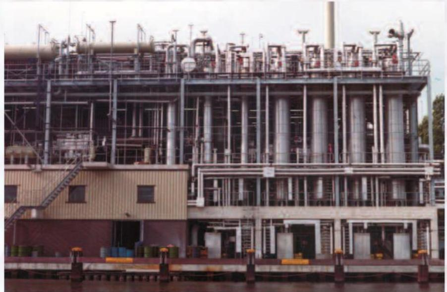
Mehrstufige Fallfilmverdampferanlage für Miscella-Destillation
