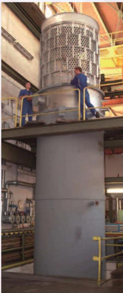
Dünnschichtverdampfer im Prüfstand
