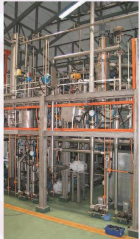
Pilotanlage zur Methylesternverdampfung
