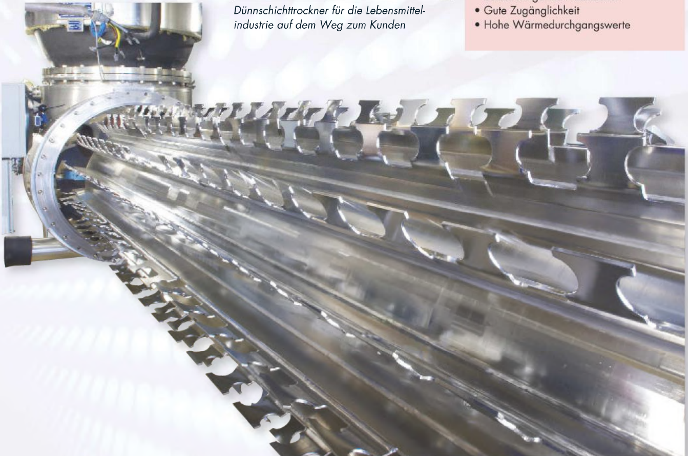
Horizontaler Dünnschichttrockner mit ausgefahrenem Rotor
