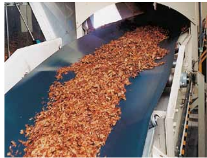
Horizontaltransport mit muldungsfähigem Band. Die Zugträger-Konstruktion bewirkt die Biegeweichheit in der gewünschten Richtung.
