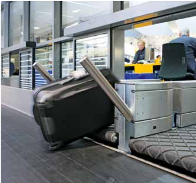
Sammelband im Check-In-Bereich eines Flughafens. Die gute Planlage des eingesetzten Bandtyps gewährleistet auch bei größeren Bandbreiten problemloses seitliches Aufschieben des Transportgutes. Die schwer entflammbare Ausführung ist ein „Muss“ in modernen Flughäfen.
