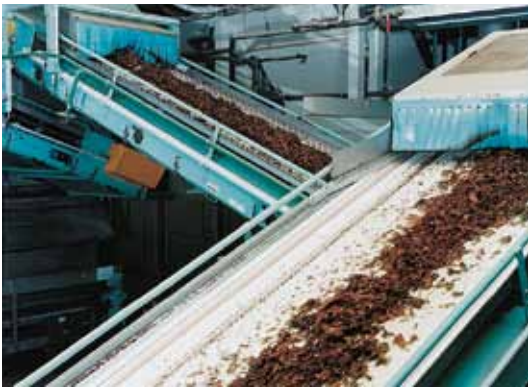
Schrägförderung in der Tabakindustrie. Bis zu einem Förderwinkel von 22° können in diesem Bereich auch Bandtypen mit glatten Oberflächen eingesetzt werden.
