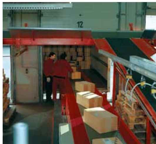
Teleskopbänder – hier bei der LKW- Beladung eingesetzt – müssen für den Lauf mit Gegenbiegung ausgelegt sein und gleichzeitig hohe Punktlasten bewältigen.
