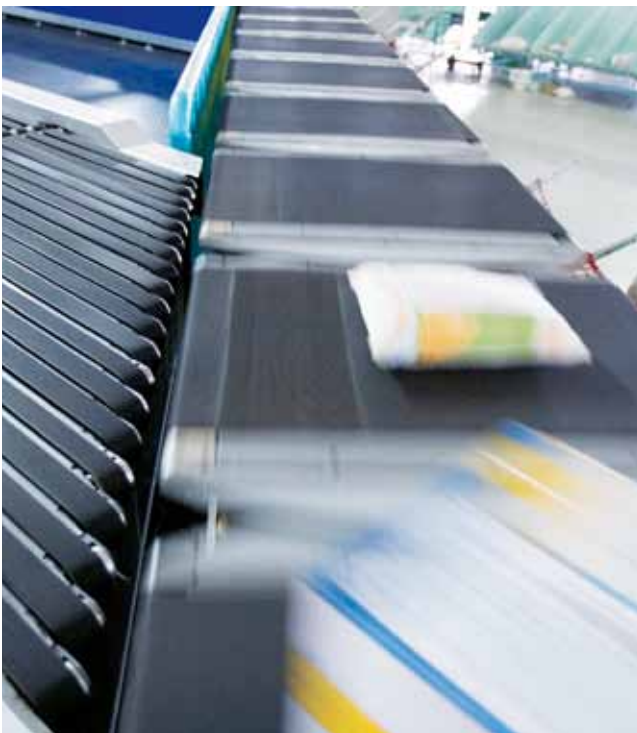
Quergurtsorter in einem Verteilzentrum. Die hohe Beschleunigung erfordert extrem gute Reibwerte der Bandoberfläche.
