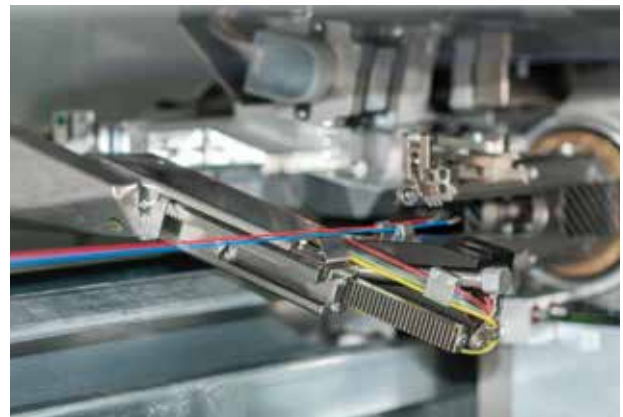
▲ Transferbrücke Mit motorisierten Achsen
