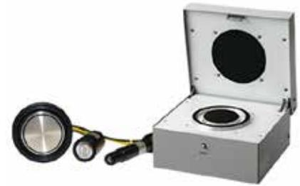
Messbox für Messungen nach JIS K 6911-1995
