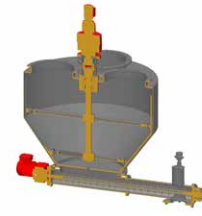
Pufferbehälter mit Rührwerk
