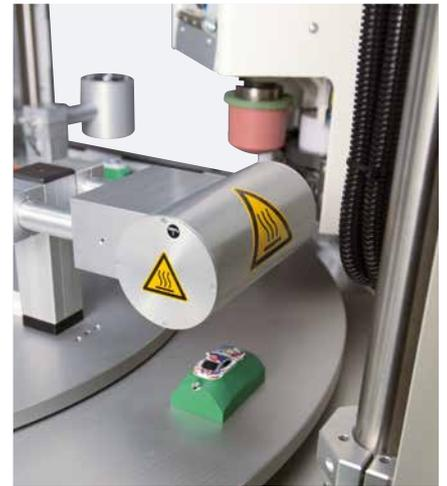
**Komponente Infrarottrocknung – verkürzt die Trockenzeit der Tampondruckfarbe**
