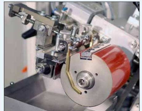
Abb.: Spannwalze montiert im Rotations-Tampondruckwerk
