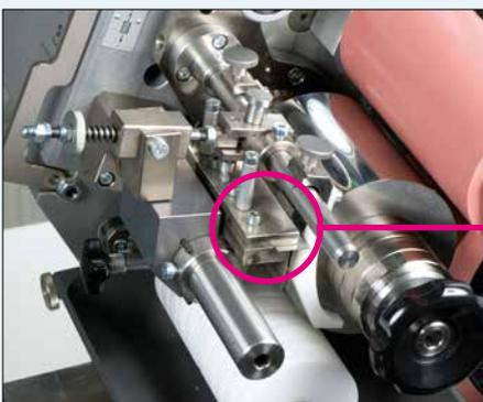
Abb.: CP-Klischeewalze eingebaut im Rotations-Tampondruckwerk RTI 21-150
