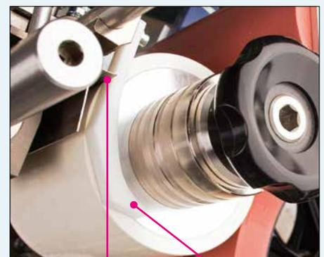
Abb.: Rotationsdruck-Rakelmesser und Abstreifer POM garantieren im Zusammenspiel mit der Klischeewalze einen sicheren und stabilen Prozessablauf
