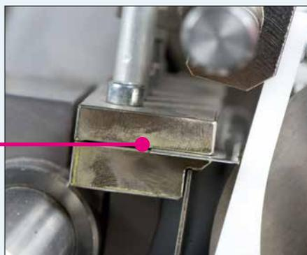
Abb.: Detailsicht Rotationsdruck-Rakelmesser eingebaut in Rakelmesshalter
