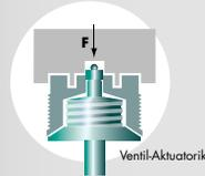
Überwachung von Einpressen und genauem Positionieren der Ventil-Aktuatorik bei der Montage von Common-Rail-Injektoren.
