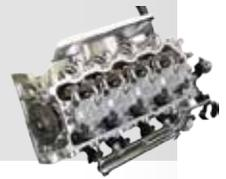
Mehrkanal-Fügeüberwachung in der Zylinderkopfmontage. Der synchrone Prozess beim Fügen von Ventilsitzringen und -führungen wird erfasst und ausgewertet. DigiControl PC-Software protokolliert und visualisiert die Prozessdaten von bis zu 32 Controllern.
