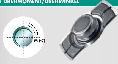
Drehmoment-/Drehwinkelkontrolle bei Kfz-Bedienelementen. Das haptische Verhalten von Drehschaltern wird anhand des Drehmoment-/Drehwinkel-Verlaufes ausgewertet.
