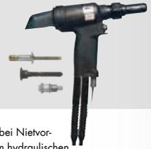
Überwachung des Setzprozesses bei Nietvorgängen für ABS-Komponenten. Am hydraulischen Setzwerkzeug werden Öldruck und Ölolumen-durchfluss erfasst und ausgewertet.
