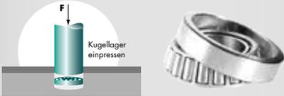
Überwachung des Einpressens von Kugellagern in Lagerschalen.
