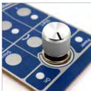
Folientastatur mit Drehgeber
