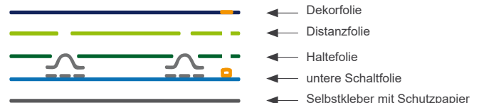
Folientastatur mit Schnappscheiben und LED
