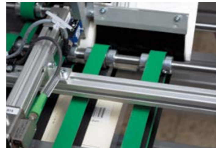
Modell HSFeco – Serialisierung von Postkarten
