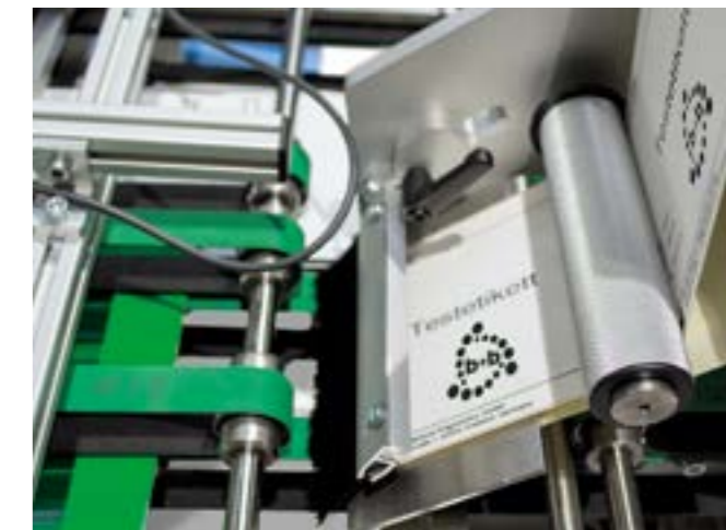
Modell HSF-500eco – Serialisierung von Faltkartons
