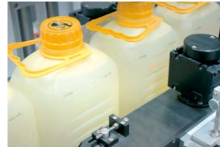
Gebindeetikettierer GKM-PV mit Aufbringung und Verifizierung der Seriennummern – vollintegriert in b+b Siteserver
