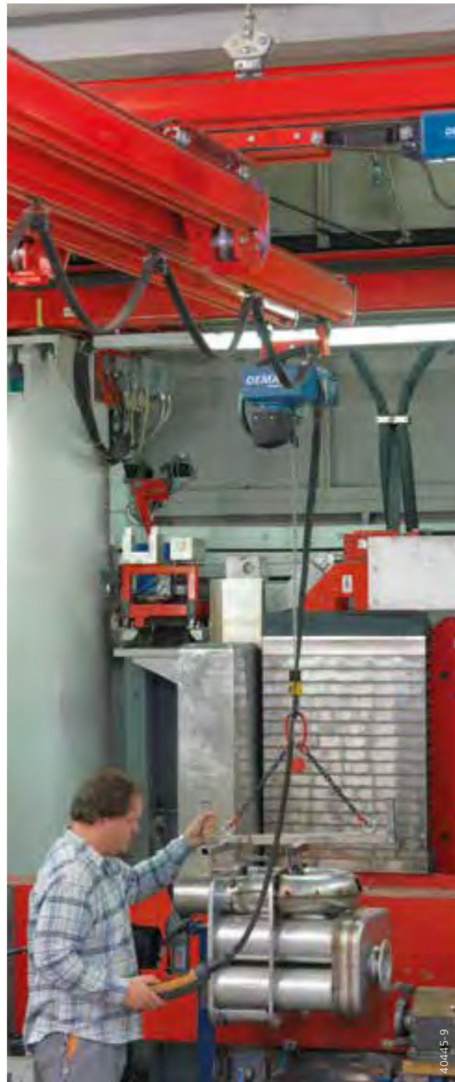
Ausschiebekran in Einträgerausführung
