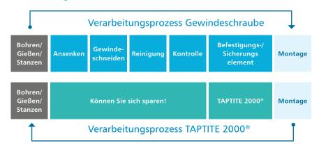
Wenn Sie TAPTITE 2000® verwenden, sparen Sie nicht nur Zeit beim Verarbeitungsprozess, sondern auch Kosten für den Einsatz von Werkzeugen und Maschinen. So entfällt zum Beispiel das Bearbeitungszentrum inklusive Waschanlage für die betroffenen Verschraubstellen, wie es für Gewindeschrauben notwendig ist, oder die Messmittelbeschaffung zur Lehrenhaltigkeitsprüfung sowie zusätzliche Sicherungselemente.
