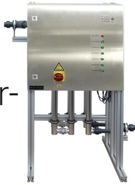
Die PURION PRO Mehrstrahler-Anlage 2500 / 6 ist zur UV-Desinfektion für größere Durchsätze bei Spezialflüssigkeiten mit sehr geringer Transmission ausgelegt. Der Steuerungsschrank kann mit Lebensdauerüberwachung (OTC 2) ausgestattet werden. Der potentialfreie Kontakt D1-D2 (Fehlersummensignal) ermöglicht die einfache Integration in bestehende Überwachungskonzepte.
