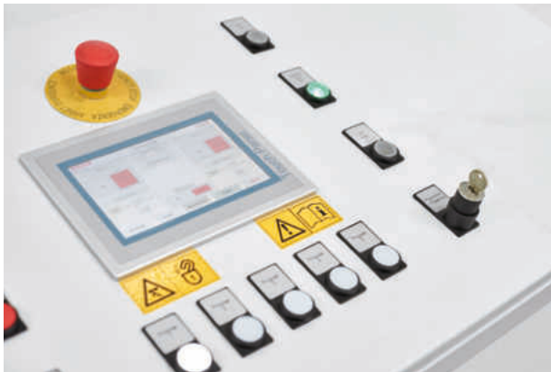
Bedienpult mit Hauptschalter, Not-Aus-Schalter und Programmwahl-tasten.
