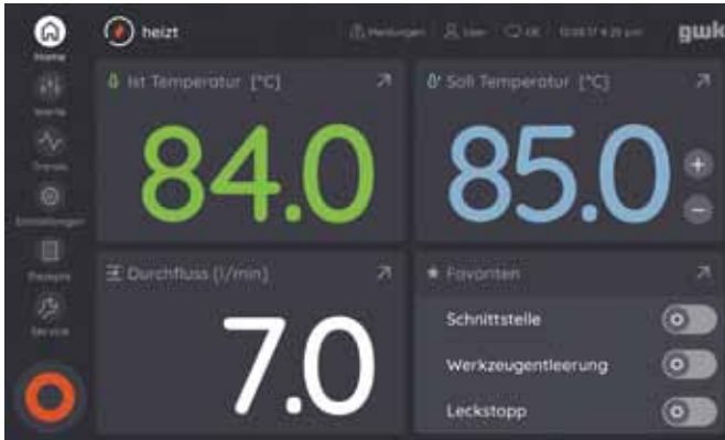
Anzeige- und Bedieneinheit logotherm mit gestenfähigem 7" Multitouchdisplay
