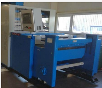
in Serie Materialverwaltung Geraderichter und Spaltanlage
