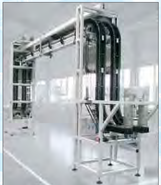
Fahrbahnüberführung mit separatem Verbindungsförderer
