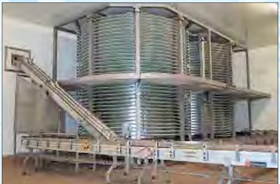
Wendel-Durchlaufsystem mit umlaufender Galerie
