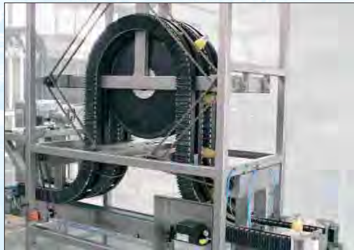
Kopfraumbenutzer mit Umlenkscheibe zur Reduzierung des Ketten- und Gleitleistenverschleißes
