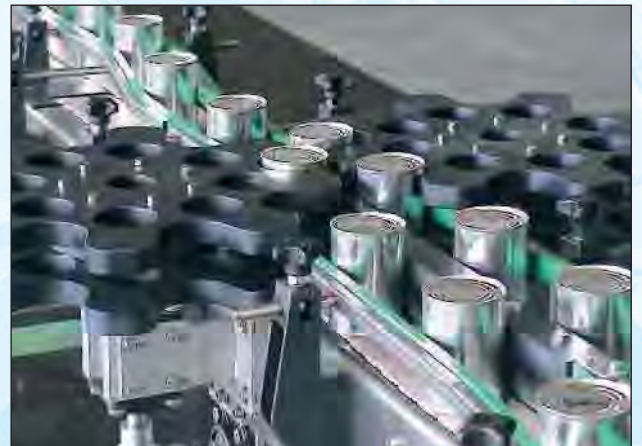
Verteilersterne von 1 auf 2
