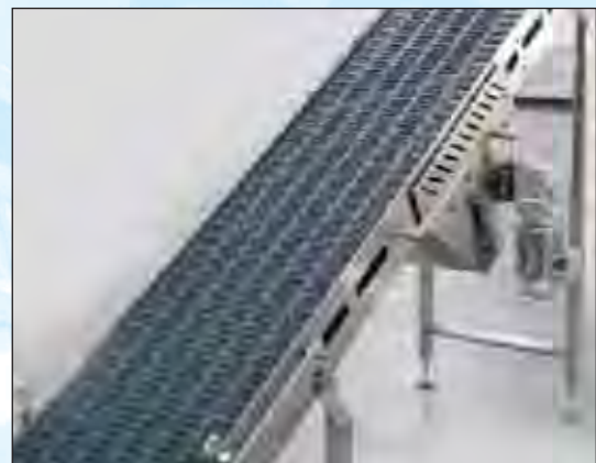
Förderer für Kartongebinde mit 40° Steigung
