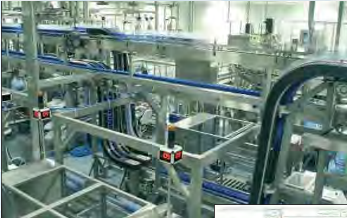
Kompakte Fördertechnik unter Reinraumbedingungen
