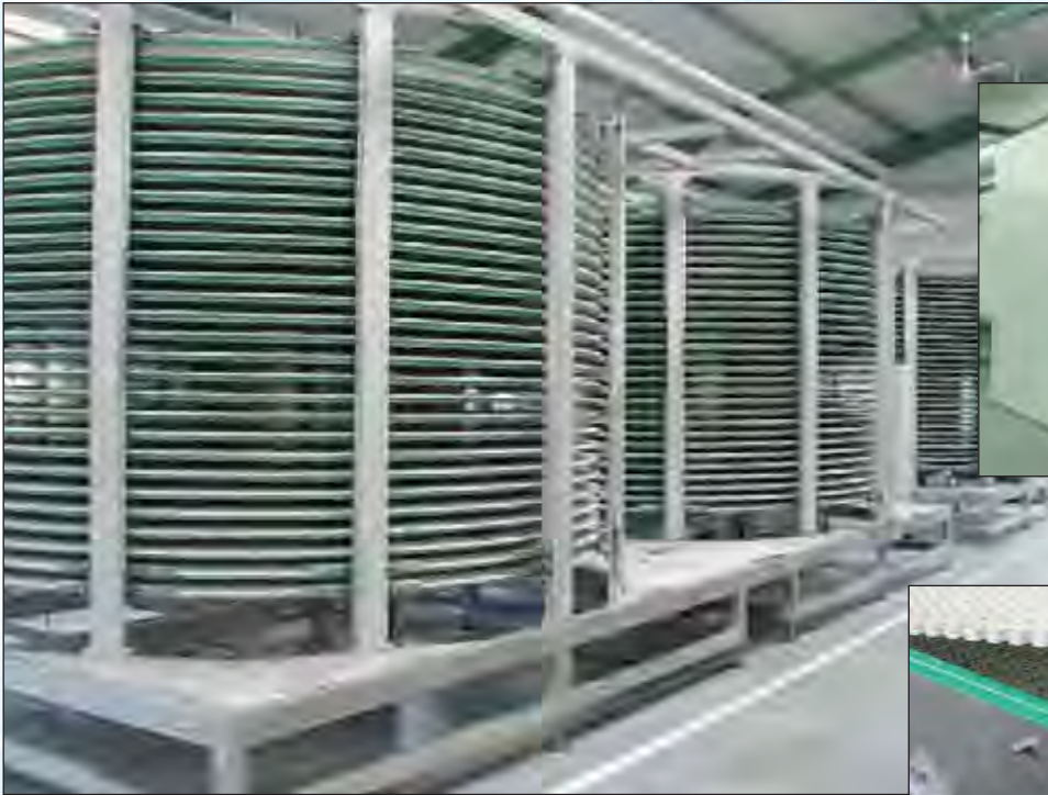
Dreiturm-System mit über 1.200 m Kettenlänge
