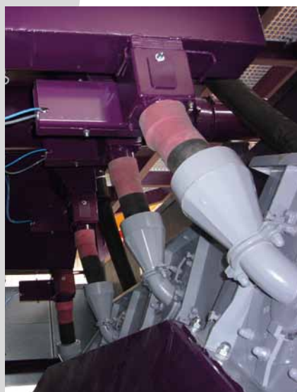
AGTOS-Hochleistungsturbinen auf einer Rollbahn-Strahlanlage.
