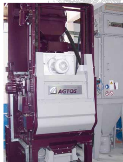
AGTOS-Hochleistungsturbinen auf einer Muldenband-Strahlanlage.
