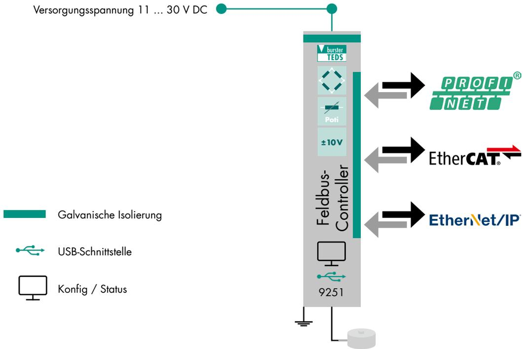
Blockschaltbild – Mehrkanalanwendung mit Universal Messverstärker, Feldbus-Controller mit Messeingang und Kraftsensoren
