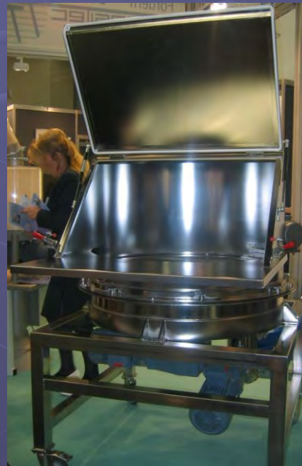
Ausführung elektrolytisch poliert, mit Vibrationsrahmen und Verwiegung, ausgeführt als mobile Station
