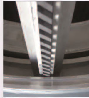
Rotor mit radial beweglichen Wischerelementen aus PTFE oder Graphit
