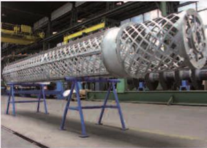
Rotor mit radial beweglichen PTFE-Wischerelementen
