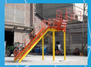
Die Treppenwange ist auf beiden Seiten mit einem genormten Sicherheitsgeländer versehen, das aus einem Handlauf, einem Schutzrohr und einer Fußleiste besteht. Die Höhe des Klappstegs läßt sich variieren. Durch seine besondere Kinematik ist er leicht von Hand bewegbar.
