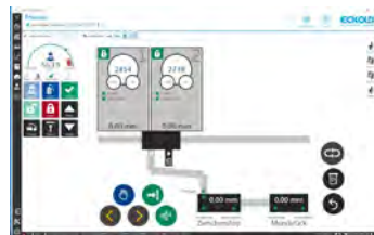
Angeschlossene Nietzuführstationen werden mit überwacht.
