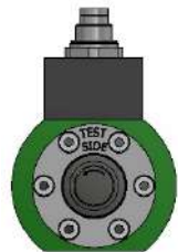
Abbildung 23: Linksdrehendes Drehmoment (Blick auf die Messeite)
