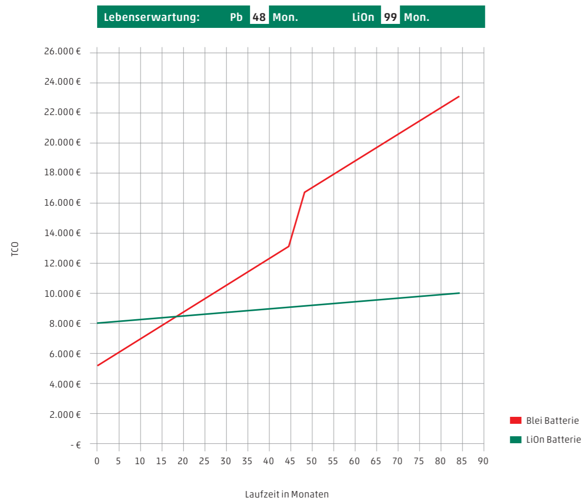
TCO-Entwicklung von Blei-Säure (250 Ah) und Lithium-Ionen (120 Ah) im Vergleich für einen üblichen Anwendungsfall.
