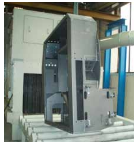
Strahlanlage für Bleche, Profile und Konstruktionen mit Durchlaufhöhe bis zu 1000 mm
