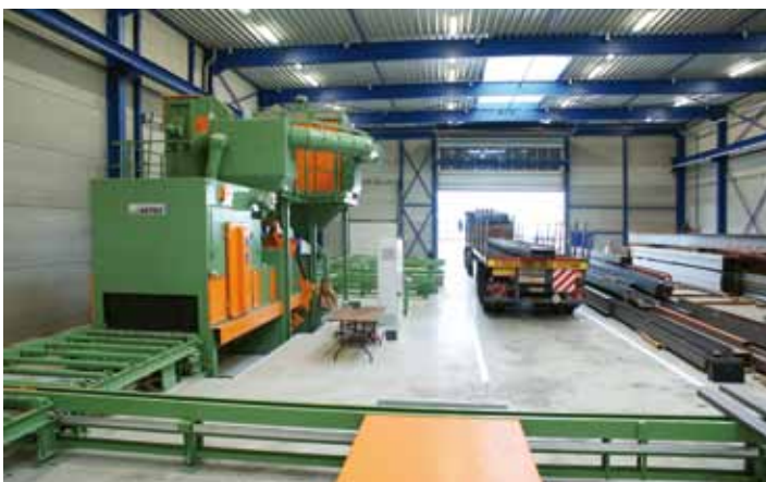
Quertransporte verbinden die Rollbahn-Strahlanlage mit den Säge-Bohr-Anlagen.
