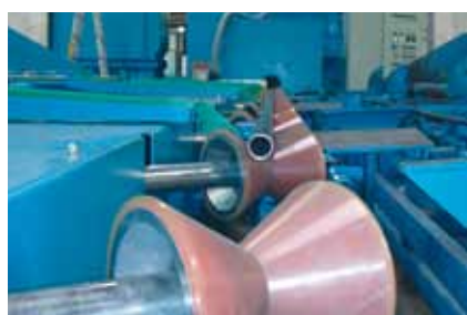
Diabolo-Rollen-Strahlanlage zur Bearbeitung von Sprinklerrohren
