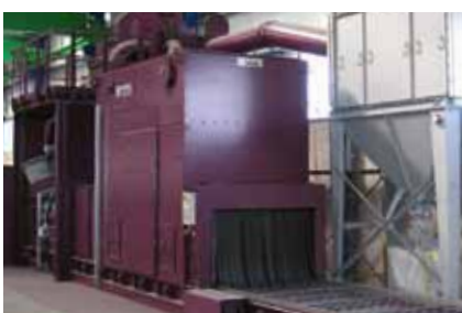
Strahlanlage für Bleche, Profile und Konstruktionen mit Durchlaufhöhe bis zu 1000 mm
