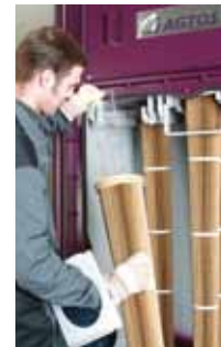
Schnellwechselverfahren für Filterpatronen
