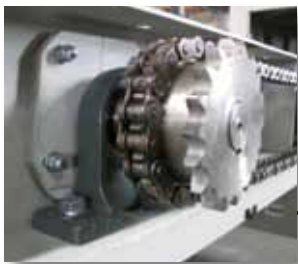
Stehlager der Transportrollen sind außerhalb der Maschine installiert
