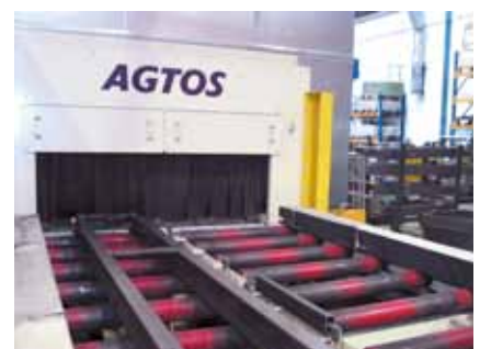
Strahlanlage mit variabler Durchlaufhöhe
