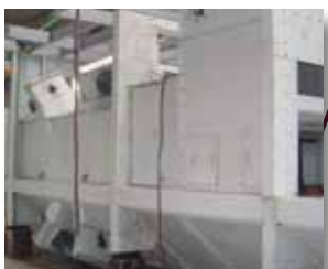
Maschinengehäuse mit Strahlkammer aus Manganstahl
