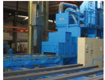
Strahlanlage mit variabler Durchlaufhöhe
