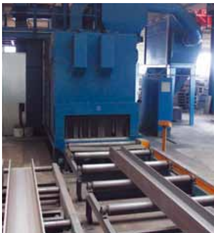
Strahlanlage für Großprofile
