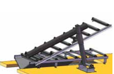
Kippvorrichtung zur Strahlmittel-Entleerung von Rohren nach dem Strahlvorgang
