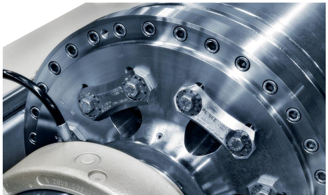
Die Abbildung zeigt einen Dekanterrotor mit verstellbaren Wehrplatten
