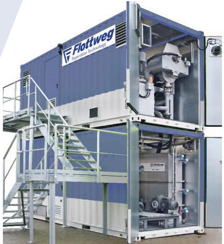
Containeranlagen für die Aufbereitung von Bohrschlamm
