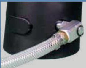
Mehrere Druckluftanschlüsse für die immer korrekte Arbeitsposition für Rechts- und Linkshänder.
