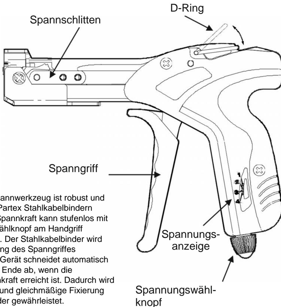
Das praktische Spannwerkzeug ist robust und zur Montage von Partex Stahlkabelbindern vorgesehen. Die Spannkraft kann stufenlos mit dem Spannungswählknopf am Handgriff eingestellt werden. Der Stahlkabelbinder wird durch die Betätigung des Spanngriffes festgezogen. Das Gerät schneidet automatisch das überstehende Ende ab, wenn die eingestellte Spannkraft erreicht ist. Dadurch wird eine zuverlässige und gleichmäßige Fixierung der Stahlkabelbinder gewährleistet.
