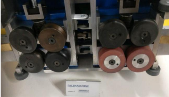
Gummierte Antriebsrollen (Blechbeförderung)
