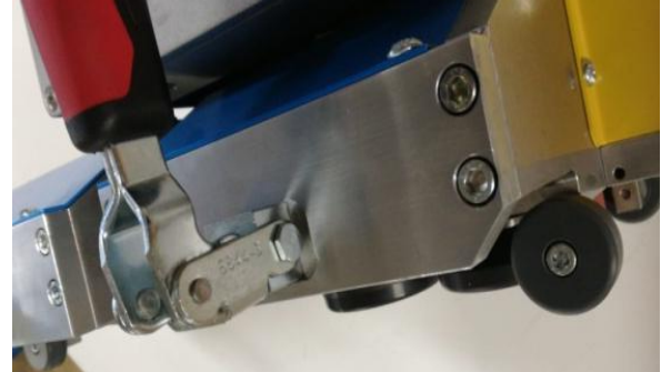
Klemmmechanismus mit Handgriff
