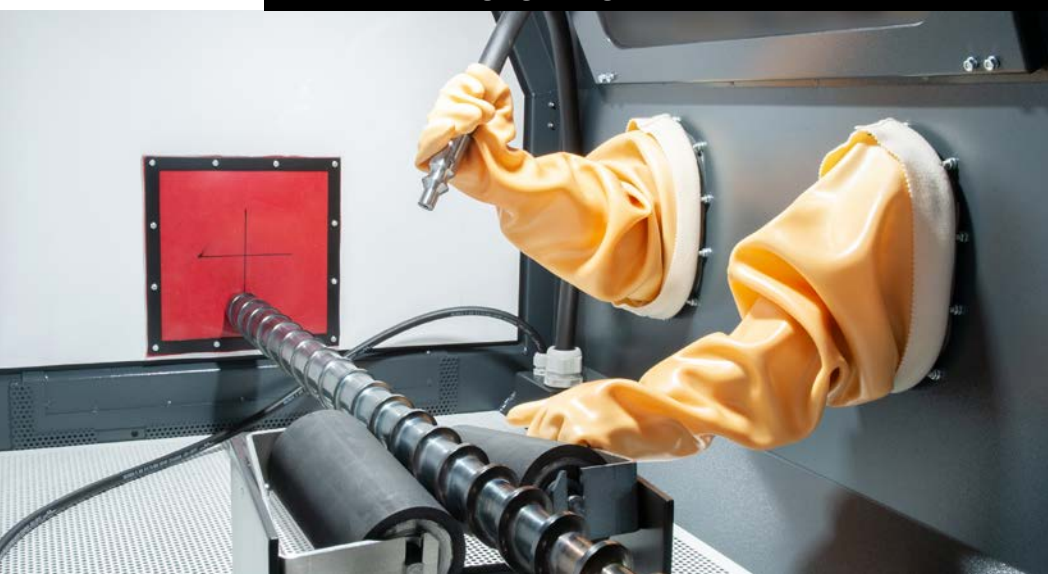
Mechanische Reinigung mit organischen Strahlmitteln
