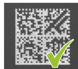
Gelasertes Code auf Kunststoffoberfläche
