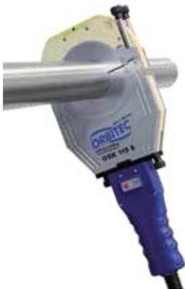
Bei geschlossenen Schweißköpfen besteht bauartbedingt ein kompletter Decklagenschutz der Schweißnaht durch eine permanente Umflutung der Schweißnaht während des Schweißvorganges mit Schutzgas. Dies ermöglicht sehr anlauffarbenarme Nähte.
